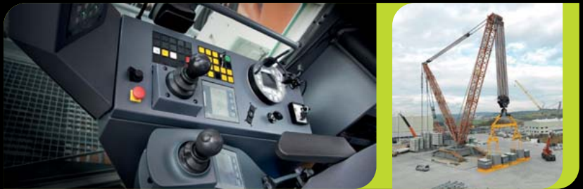
Liebherr-Raupenkran LR 13000 mit 3.000 Tonnen maximaler Traglast Liebherr, Ehingen
